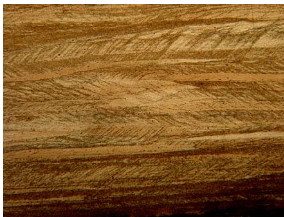
Figura 1. Micrografía de una muestra homogeneizado-solubilizada-templada y posteriormente laminada un 84% (magnificación 5X)
