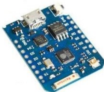
Fig. 3. La board Wemos D1 mini pro
