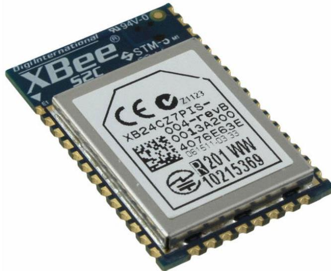
**Fig. 8 - Módulo Xbee SMD<sup>7</sup>.**
