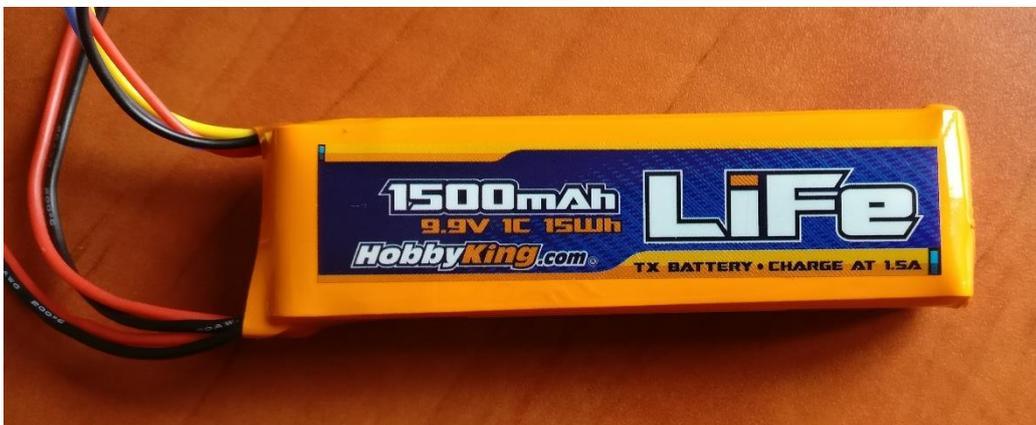
Fig. 35 – Bateria de Fosfato de Lítio e Ferro (LiFePO<sub>4</sub>).
