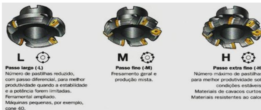
Figura 25 - Classificação do passo das fresas (Sandvik, 2010)
