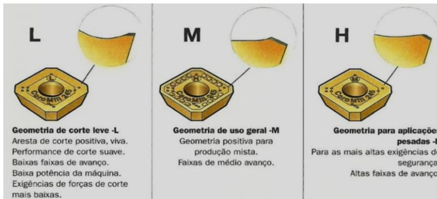
Figura 24 - Tipificação das geometrias dos insertos de corte (Sandvik,2010)
