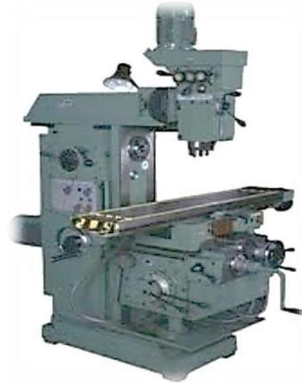
Figura 4 - Fresadora horizontal convencional (Cenfim.pt)
