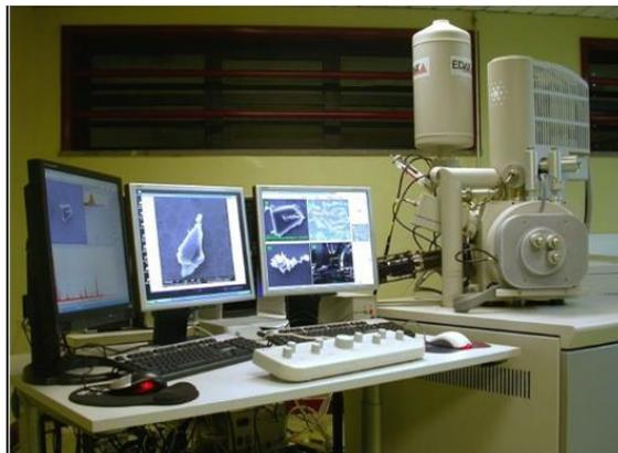
Figura 57 - Microscópio electrónico de varrimento FEI Quanta 400 FEG (CEMUP)
