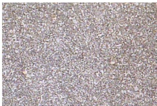
Figura 50 - Microestrutura sinterizada do microgrão (1500x) (Palbit)
