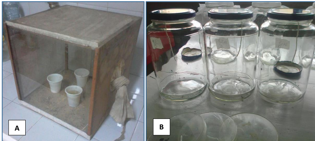
Figura 1: a) Jaula entomológica de cría de adultos y b) Frascos de vidrio para bioensayos.
