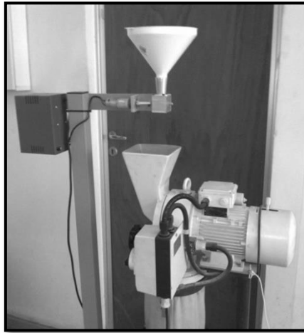
Figura 5.3. Vista del dosificador, en posición sobre la boca de alimentación del molino.
