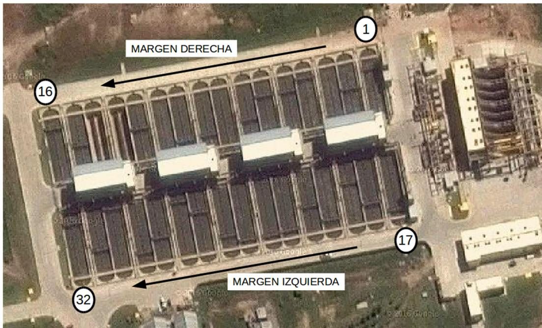
Figura 5.1.- Distribución de las unidades desarenadoras en la Planta de Pre-tratamiento de líquidos cloacales del Bicentenario.
