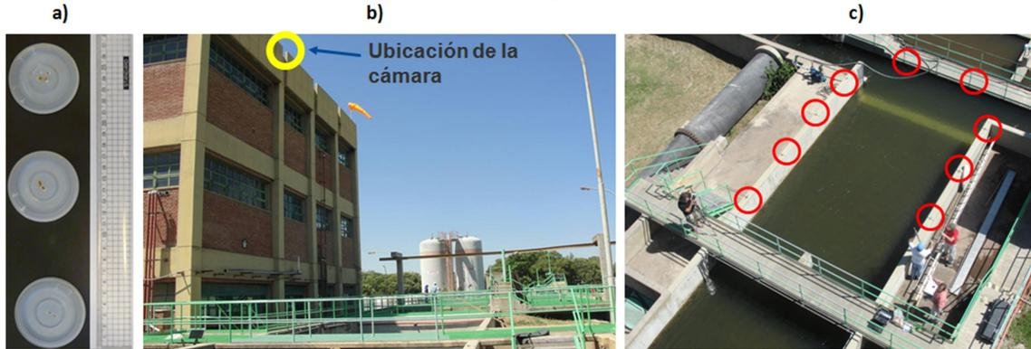
Figura 3.4.- a) Partículas trazadoras adoptados en este estudio; b) Ubicación de la Cámara digital en la implementación de la técnica PTV en la campaña 5; c) Marcas de referencia utilizadas en el proceso de rectificación.
