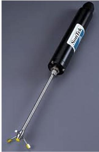
Figura 2.1.- Velocímetro Acústico Doppler Micro ADV YSI Sontek de 16 MHz de frecuencia acústica utilizado en la caracterización experimental.
