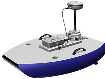
Figura 2.2.- Perfilador de Corriente Acústico Doppler (ADP) "RiverSurveyor S5" utilizado en la caracterización experimental.
