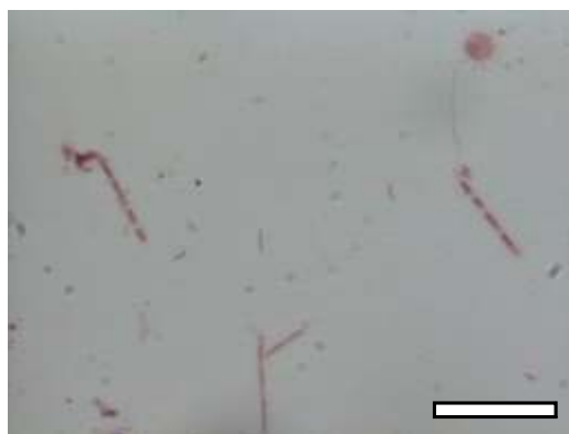
Figura 4. Microscopio óptico 400x: Bacterias filamentosas presentes en el agua cruda, barra 20 µm
