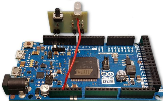
Figura 9.7: Tarjeta de E/S insertada en la Arduino Due
