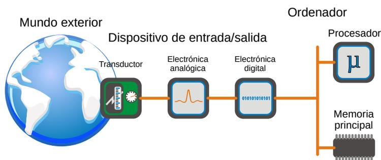
Figura 8.1: Estructura de un dispositivo de entrada/salida
