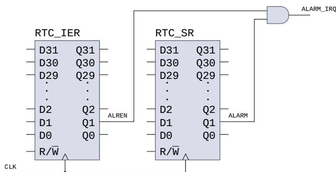
Figura 10.2: Elementos de un dispositivo que intervienen en una petición de interrupción. La petición de interrupción ALARM\_IRQ de un reloj en tiempo real (RTC) solo se activará cuando se active el bit ALARM del registro de estado RTC\_SR al saltar la alarma y esté habilitada la petición de interrupción por alarma (bit ALREN del registro de control RTC\_IER a 1)
