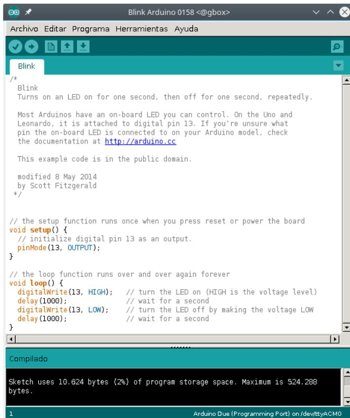
Figura 9.11: Resultado de la compilación del proyecto «Blink»
