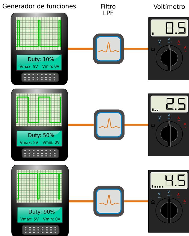
Figura 10.3: Método PWM para la conversión Digital/Analógica
