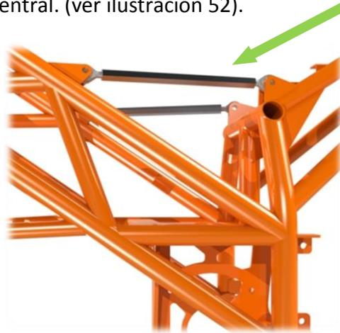
Ilustración 52: Detalle de los tirantes desmontables del chasis final.
