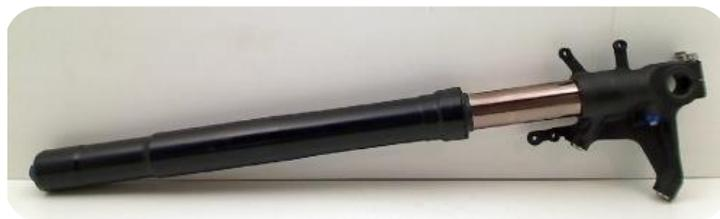
Ilustración 91: Barra horquilla delantera.
