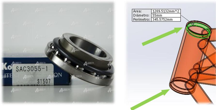
Ilustración 56: Detalle del rodamiento de dirección y su alojamiento.
