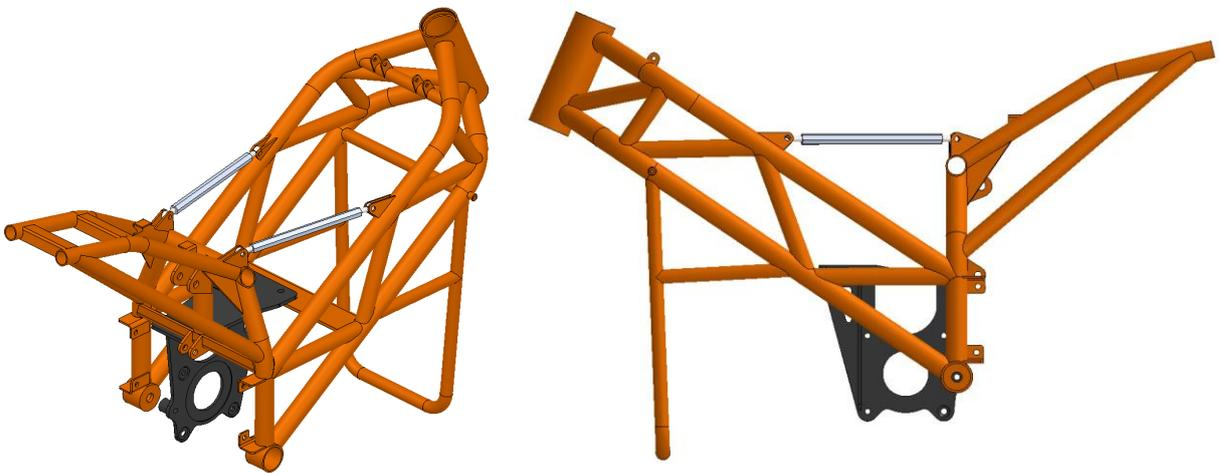
Ilustración 30: Chasis multitubular acero V2.
