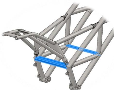
Ilustración 27: Detalle travesaños centrales chasis acero V1.
