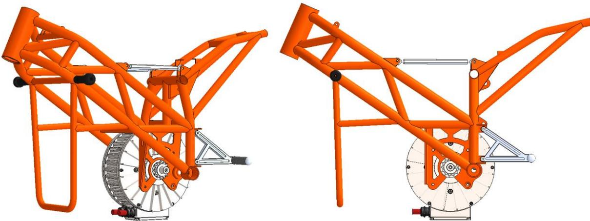
Ilustración 46: Detalle del concepto de chasis multitubular de acero V3 con el motor montado.
