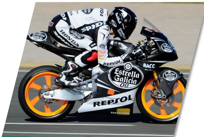
Ilustración 9: Piloto situado en posición aerodinámica sobre una motocicleta de competición de categoría moto 3.
