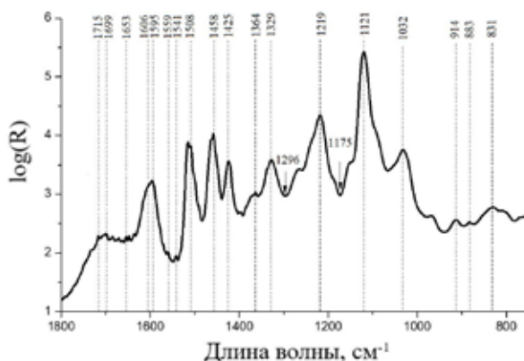
Рис. 1. ИК-Фурье спектр лигнина, полученного из опилок. Условия органосольвентной варки: загрузка обессмоленной биомассы 10 г, растворитель смесь вода-этанол 40/60 об. %, 90 мин, P_{\text{Ar}} 1 МПа, 190\text{ }^{\circ}\text{C}
