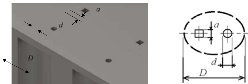
Рис. 8. Соотношение размеров глухой демпфирующей полости и расположенных над ней комбинированных перфорационных отверстий
