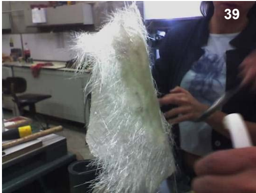
39 Se elaboran tres capas de fibra de vidrio con humectación de resina de poliéster.
