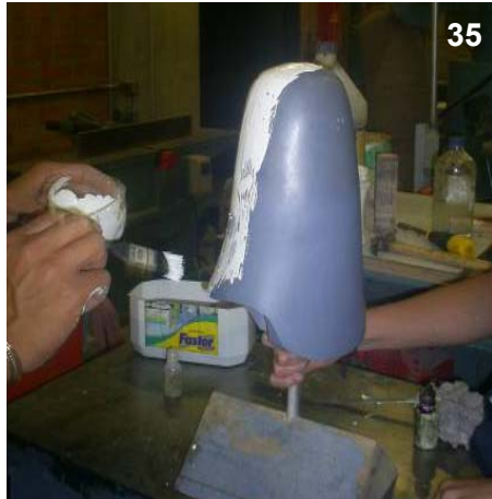
35 Posteriormente se aplica una capa de gel coat. (Este material no esta en muy buen estado, pero se decide aplicarlo para tener una superficie homogénea.)
