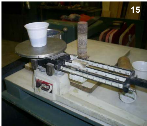
15 Se pesa 150 gr. de ARALDIT HY . Este recubrimiento se mezcla con el catalizador al 10%.
