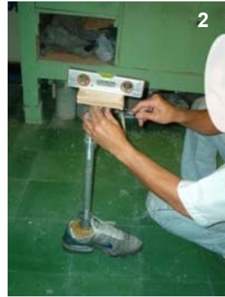
2. Se ajusta la pirámide para lograr una superficie plana como la del socket.
