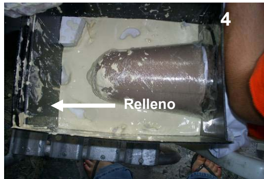
4 Al agregar los 4 Kilos de yeso fue necesario utilizar material de relleno (otro yeso), ya que no se alcanzo a cubrir la mitad.
