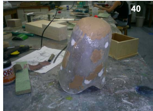
40 Se pule la pieza para mejorar la superficie del socket.
