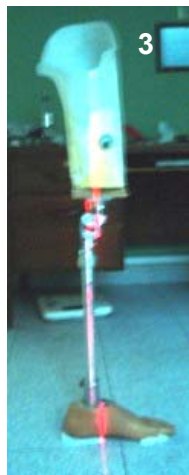
3. Con ayuda de un haz de luz lineal, se asegura que las líneas centrales sean correctas.
