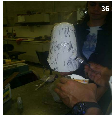
36 Se recubre el modelo en su totalidad con el gel coat (la superficie no quedo cubierta de una manera correcta al utilizar un gel coat vencido).Proceso ANEXO 2.
