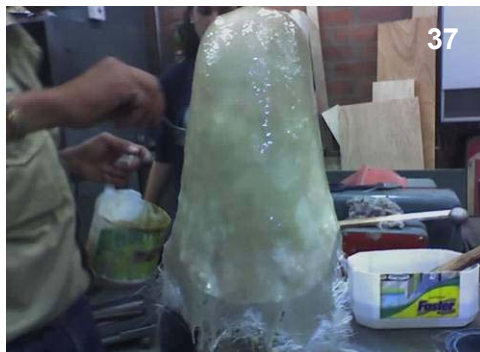
37 Luego se aplica desmoldante a la pieza y se procede a preparar la resina de la BASF con MEK-P 1% Y Co 0.1%
