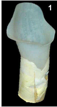
1. Socket con vaciado en espuma de poliuretano y listo para alineación
