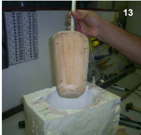
13 Se elabora un muñón de Relleno, de tal manera que se disminuya la cantidad de material.
