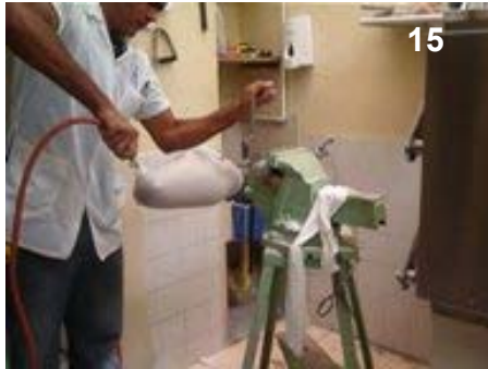
15. Se extrae el socket aplicando aire comprimido y golpeando.
