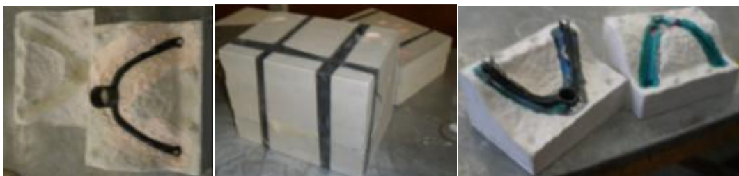
Gráfica 43: construcción de los mangos del prototipo 1 obtenidos en resina epóxica
