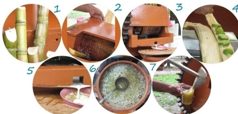
Figura 5. Pasos del proceso extracción de jugo de caña 71
