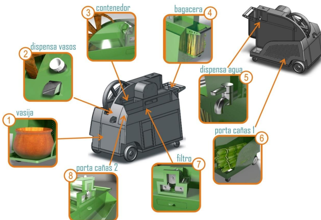
Figura 21. Acercamiento de sistemas en el trapiche.
