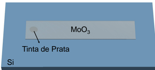
Figura 5.13: Esquema representativo da configuração das amostras utilizadas para a caracterização estrutural.
