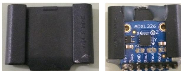
Figura 3.46- Base de plástico onde foram colocados os sensores MEMS.
