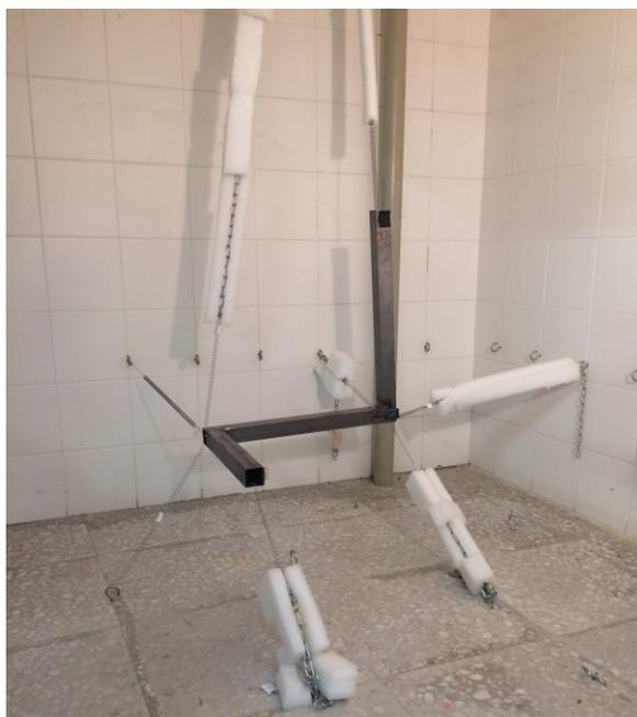
Figura 3.43- Suspensão inicial com fio Nylon unifilar e correntes de aço.
