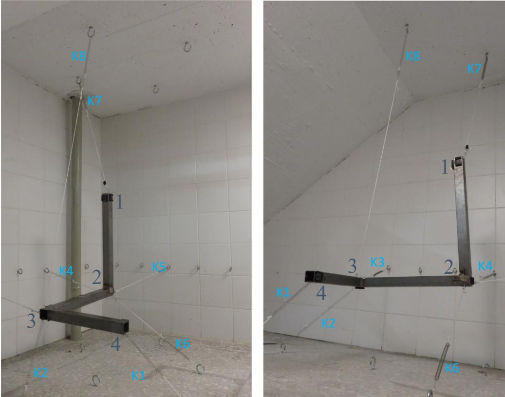
Figura 3.2- Caracterização da suspensão experimental utilizada (2 vistas).
