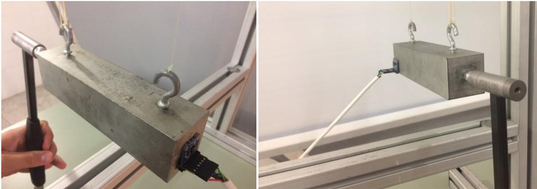
*Figura 3.3- Procedimento experimental na calibração dos MEMS triaxiais na direção z e x respetivamente.*
