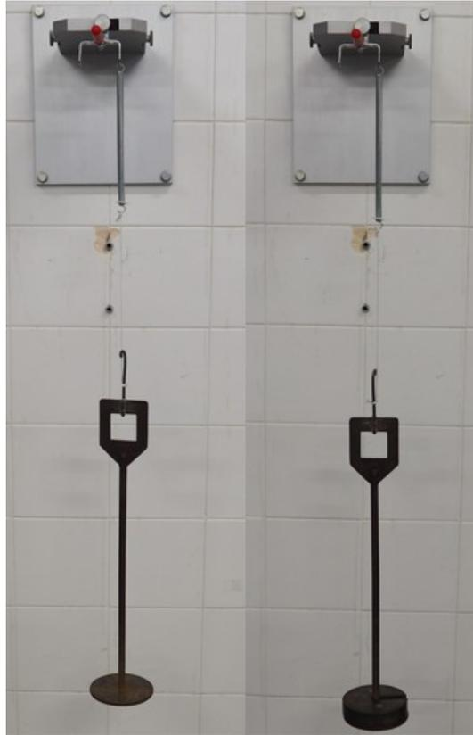
Figura 2.5- Procedimento experimental para cálculo da constante de rigidez das molas.
