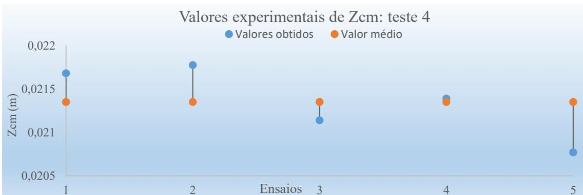
Figura 3.30- Valores experimentais do centro de massa: teste 4.
