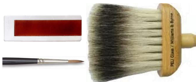
Figura 5 – Materiais utilizados para a aplicação da pintura (lâmina, pincel fino e pincel blender grande). Na lâmina apresentada (E4 AG), pode ser observado o espaço correspondente à marcação da área de pintura com fita adesiva.
