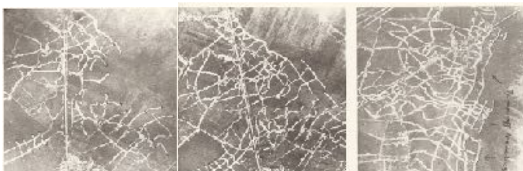
Figura 43. Série de três imagens de reconhecimento da primeira guerra mundial, mostrando a evolução da construção de um sistema de trincheiras. A segunda imagem foi tirada três dias depois da primeira e a terceira onze dias depois. A recta que divide a imagem é uma estrada (Newhall, 1969).
