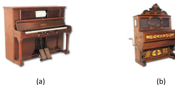
Figura 7 - Pianos mecânicos: a) Spencer, cuja acção pneumática é efectuada por pedais; (b) Bastringue, cuja manivela dá corda a uma mola. Fonte: acervo do Museu da Música Mecânica 9 .
