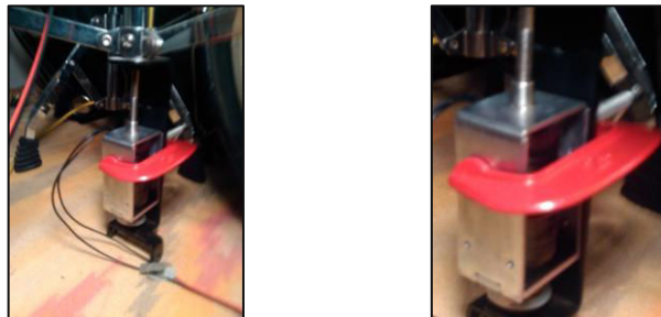
Figura 21 - Solenóide empurra o mecanismo dos pratos de choque.
