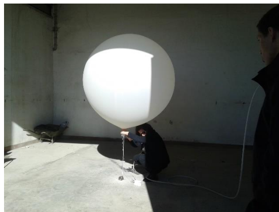
Figura 4 - Lançamento do balão atmosférico com sonda acoplada.
