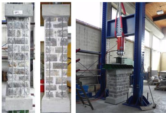
Figura 2.19 - Muretes com e sem perpianhos ensaiados à compressão [14]
