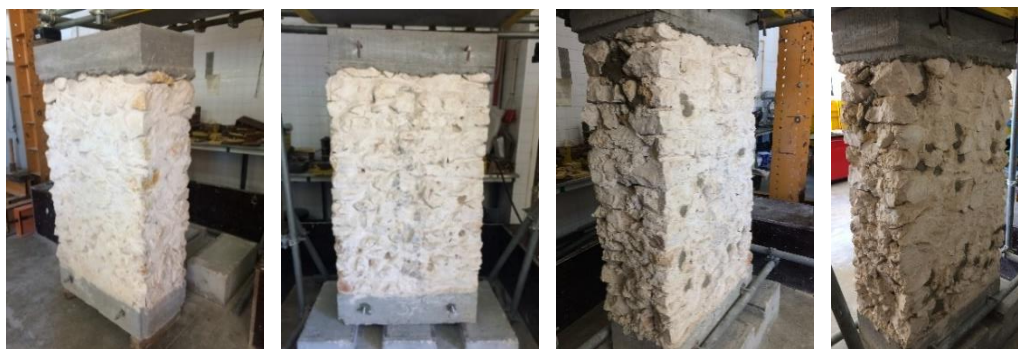
Figura 3.1 - Trabalhos de preparação do murete
