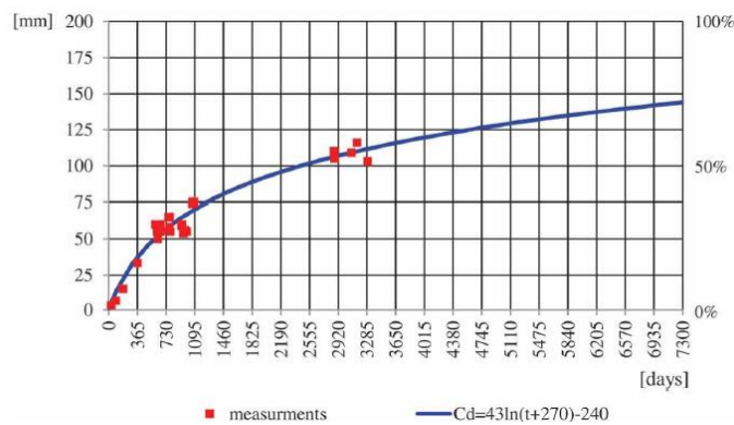
Figura 2.27 - Evolução da profundidade de carbonatação na argamassa de cal aérea ao longo do tempo (valores medidos e linha de tendência) [23]
