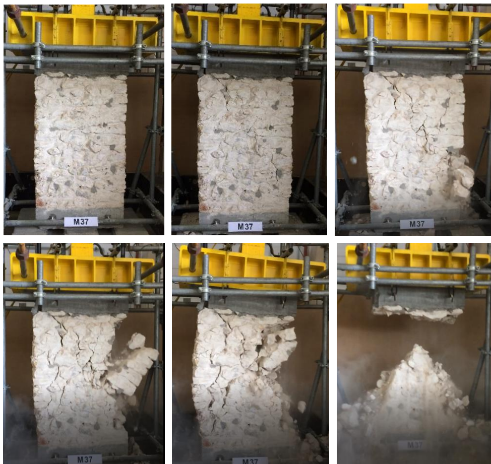
Figura 3.5 - Ensaio de compressão axial do murete M37
