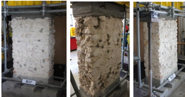
Figura 3.4 - Aspectos do murete M37, antes do ensaio de compressão axial
