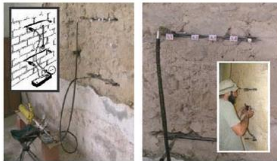
Figura 2.26 - Ensaio de macacos planos duplos [30]
