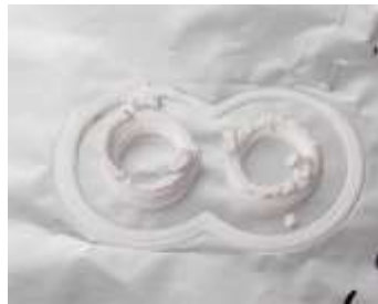
Figura 4.14 Cilindro impresso a partir da pasta 29 com a placa da impressora 3D à temperatura ambiente (Teste 15).
