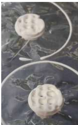
Figura 4.8 Monólitos "favo de mel" do tipo I impressos a partir da amostra 31 a 55-60°C.
