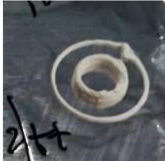
Figura 4.11 Cilindro impresso a partir da pasta 29 com a placa da impressora 3D à temperatura ambiente (Teste 11).
