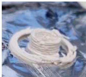
Figura 4.10 Cilindro impresso a partir da pasta 29 com a placa da impressora 3D à temperatura de 52°C (Teste 10).
