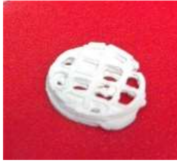
Figura 4.6 Monólito “favo de mel” do tipo I impresso a partir da pasta 14.
