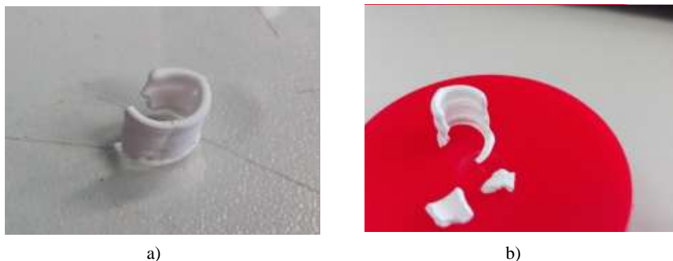
Figura 4.20 Teste de cura da peça impressa à partir da pasta 29 a 130°C: a) antes; b) depois.
