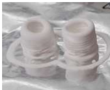
Figura 4.15 Cilindros inteiros impressos a partir da pasta 29 com a placa da impressora 3D à temperatura ambiente (Teste 16).
