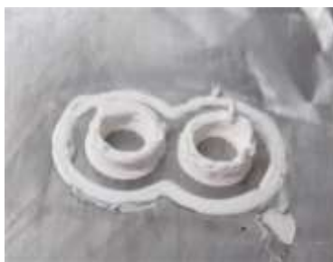
Figura 4.16 Cilindro impresso a partir da pasta 29 com a placa da impressora 3D à temperatura ambiente (Teste 17).
