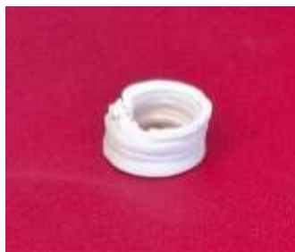
Figura 4.12 Cilindro impresso a partir da pasta 29 com a placa da impressora 3D à temperatura ambiente (Teste 12)
