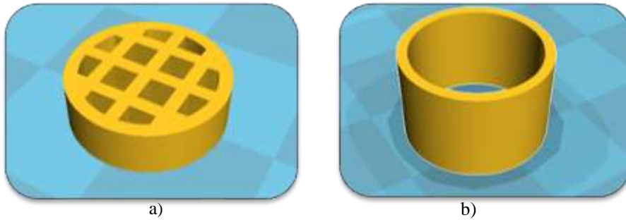
Figura 3.4 Imagens esquemáticas dos cilindros reproduzidos pelo software CURA : a) monólito “favo de mel” do tipo I; b) cilindro.
