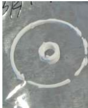
Figura 4.9 Cilindro impresso a partir da pasta 29 com a placa da impressora 3D à temperatura de 77°C (Teste 4).
