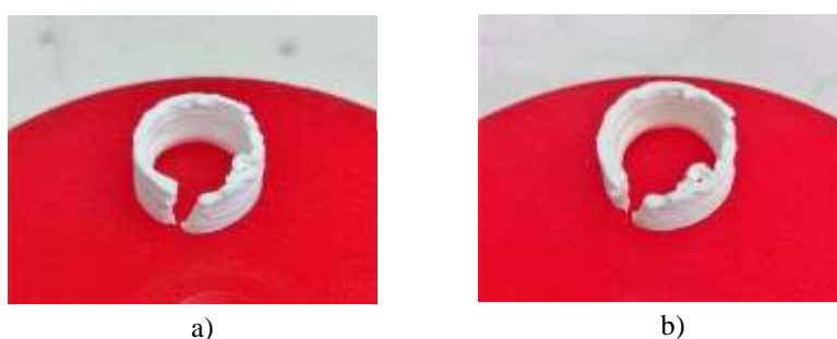
Figura 4.21 Teste de cura da peça impressa à partir da pasta 29 a 200°C: a) antes; b) depois.
