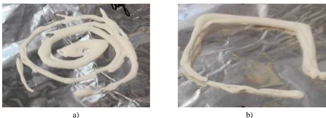
Figura 4.5 Amostra 32 extrudida a) à temperatura ambiente e b) na placa aquecida a 90°C.
