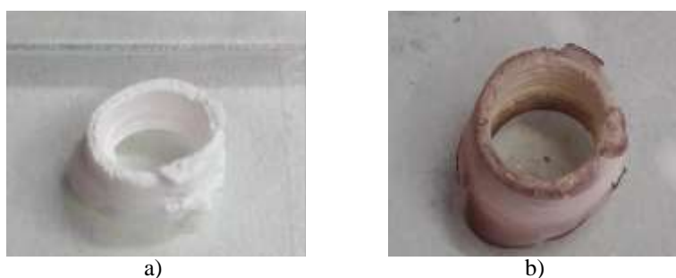
Figura 4.22 Teste de cura da peça impressa à partir da pasta 29 a 300°C: a) antes; b) depois.
