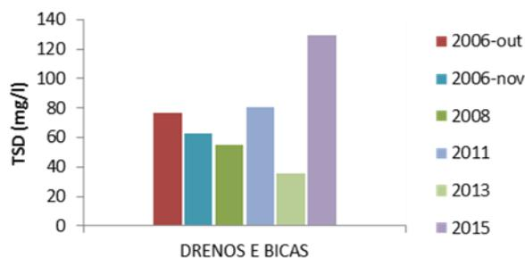
**Figura 5.17 - Barragem do Covão do Ferro. Valores médios do TSD estimados a partir dos resultados das análises das águas das bicas, em 2006, 2008, 2011, 2013 e 2015**
