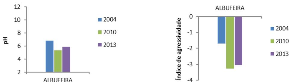
**Figura 5.4 - Barragem de Guilhofrei. Valores médios de pH e de índice de agressividade da água da albufeira em 2004, 2010 e 2013**
