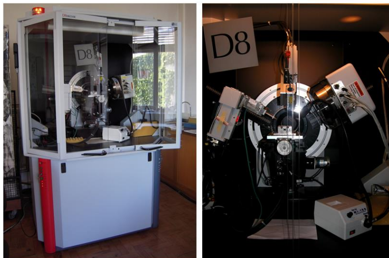
Figure 2.8. Micro-XRD installed at Laboratório José de Figueiredo.
