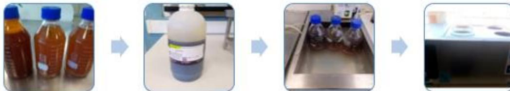
Figura 5.21. Ensaio 6 – Inativação por pasteurização (Y+80 °C/Y+85 °C – 10 minutos)
