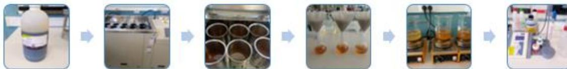
Figura 5.17. Ensaio 5 - Inativação da enzima por fervura
