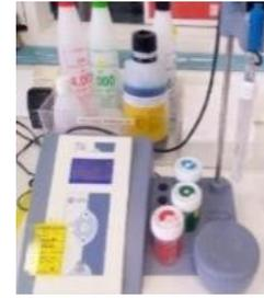
Figura 4.3. Potenciômetro de pH
