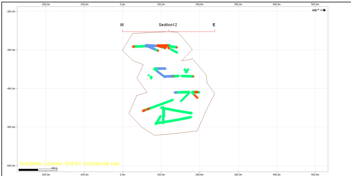
Figura 4.9 – Representação das sondagens e da linha poligonal fechada no perfil número 12
