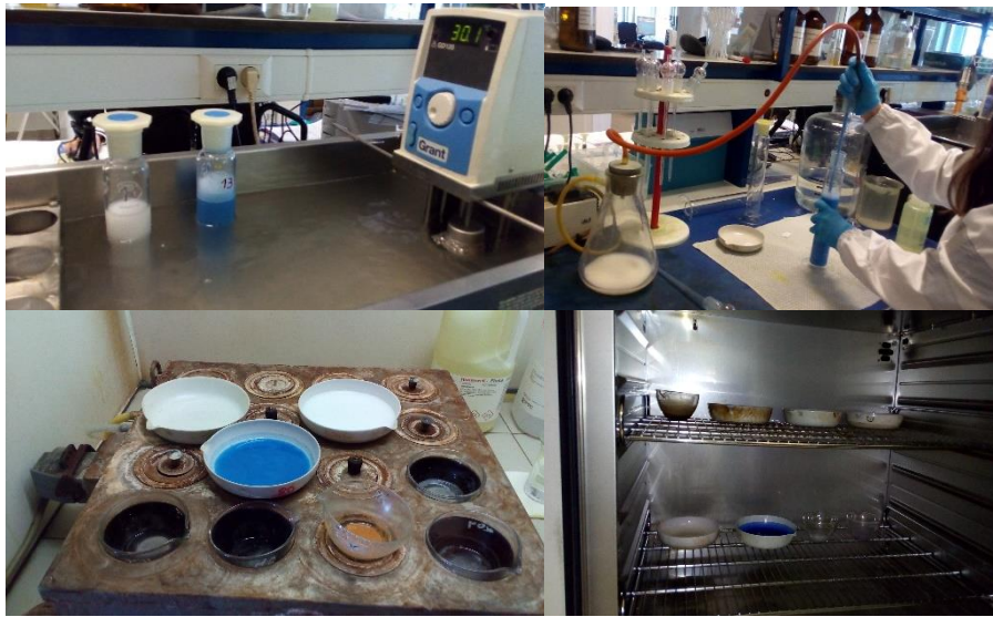
Figura 4.2 – Diferentes etapas do teste de teor em suspensão
