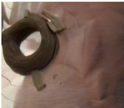
Figura 3.8 - Impressão incompleta do teste 8.
