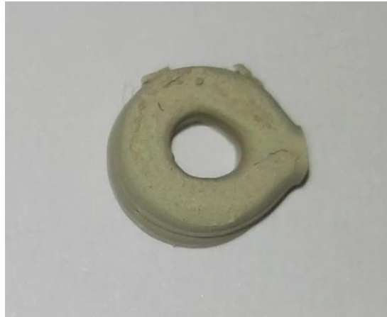
Figura 3.7 - Peça extrudada no teste 7, na placa de aquecimento a 60°C.
