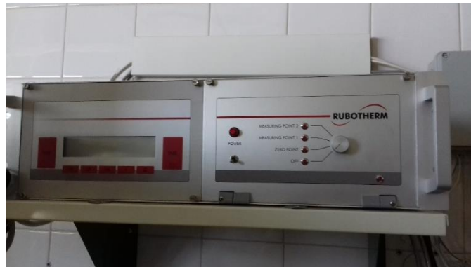
Figura 2.11 – Controlo da balança de suspensão magnética Rubotherm ISOSORP 2000.
