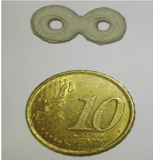
Figura 3.6 - Teste número 5, impresso a 70°C.
