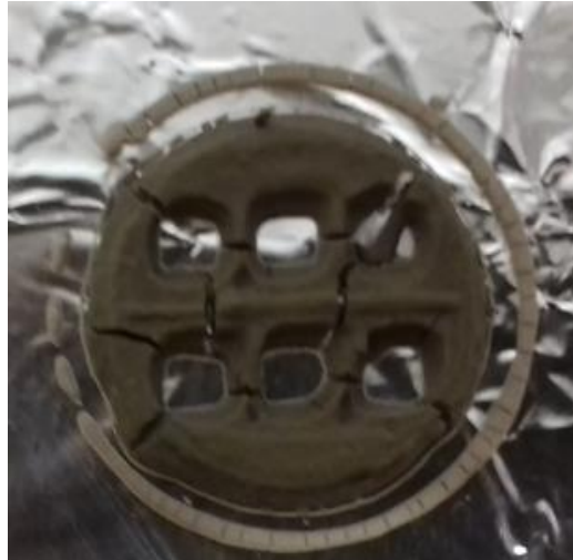
Figura 3.11 - Monólito primário de 6 canais, após secagem.
