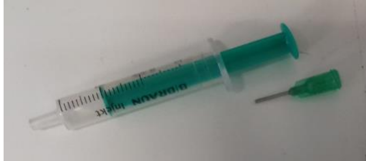
Figura 2.3 - Seringa e agulha utilizadas na impressão 3D.
