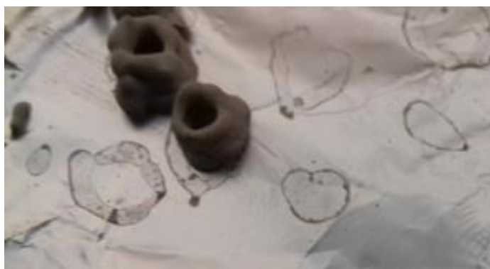
Figura 3.2 – Amostra 13 (esquerda) e 14 (direita), com geometria cilíndrica extrudidas à temperatura ambiente.
