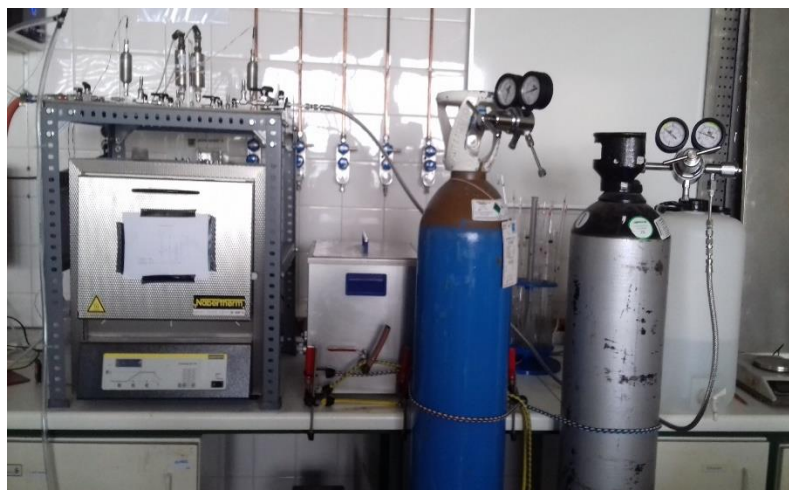
Figura 2.6 - Instalação de medição de equilíbrio de adsorção pelo método volumétrico.
