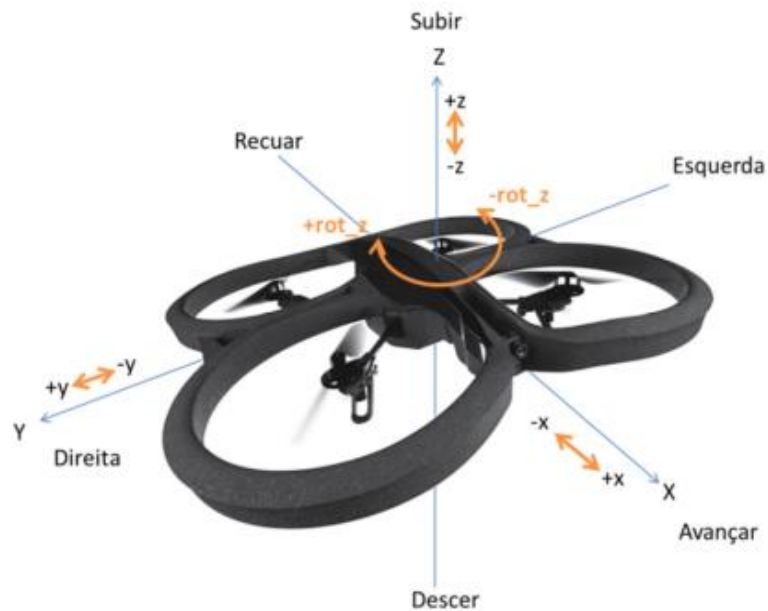
Figura 14: Sistemas de eixos e movimentos possíveis do "Ar.Drone" [28].
