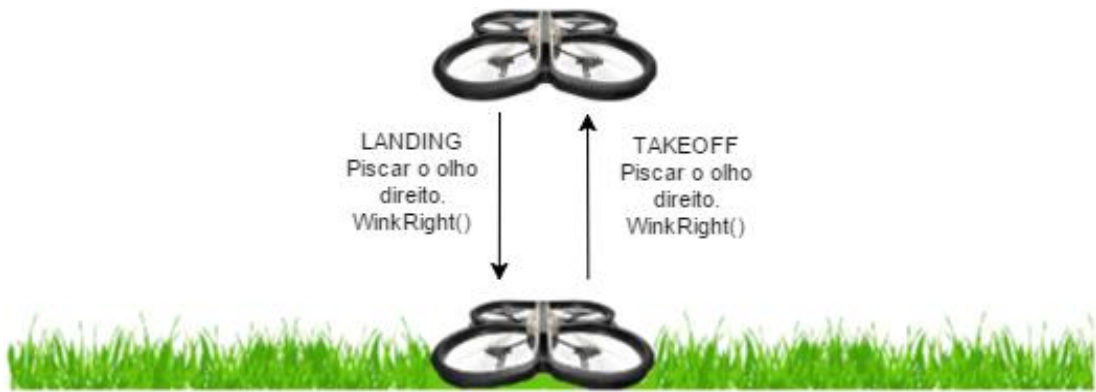
Figura 49: Representação do modo de controlo Take off e Landing do quadricóptero.
