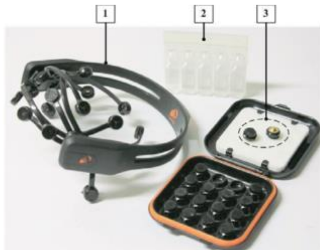
Figura 16: Capacete e acessórios [31]: 1 - Emotiv EPOC, 2 - Solução Salina, 3 - Eléttodos.
