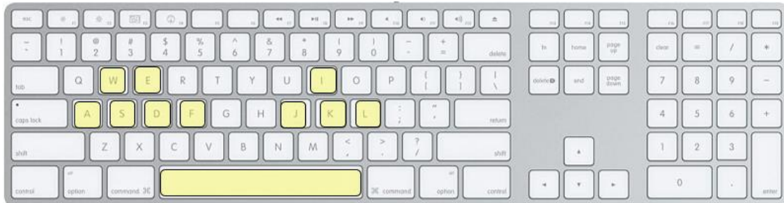
Figura 66: Teclas do teclado usadas como interface de comando do quadricóptero.
