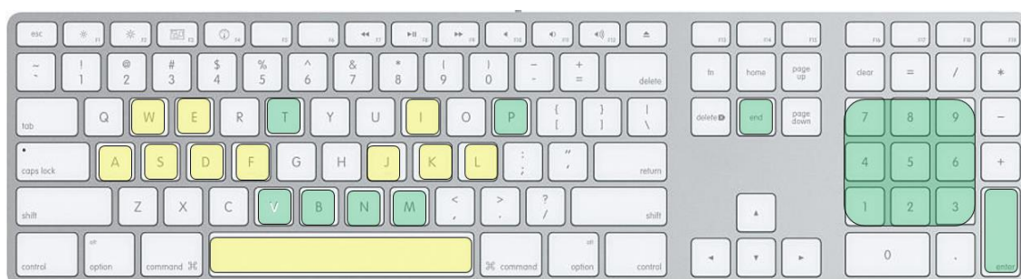
Figura 69: Teclas do teclado usadas como interface de comando do quadricóptero e do EPOC.
