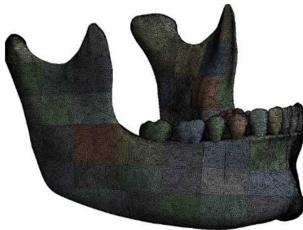
Figura 1. 30 Representação do modelo numa malha de elementos finitos, com discretização das suas propriedades (Nizo 2013).
