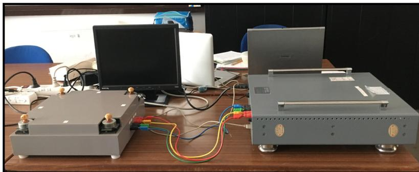
**Figura 5.1 Ensaio do quadro de Epstein**
