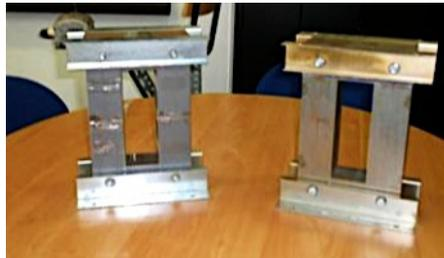
Figura 4.8 Núcleos ferromagnéticos usados nos ensaios. Retirado de (Pronto 2010)
