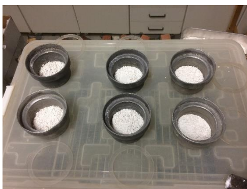
Figura A.8 – Sistema de ensaio de permeabilidade ao vapor de água
