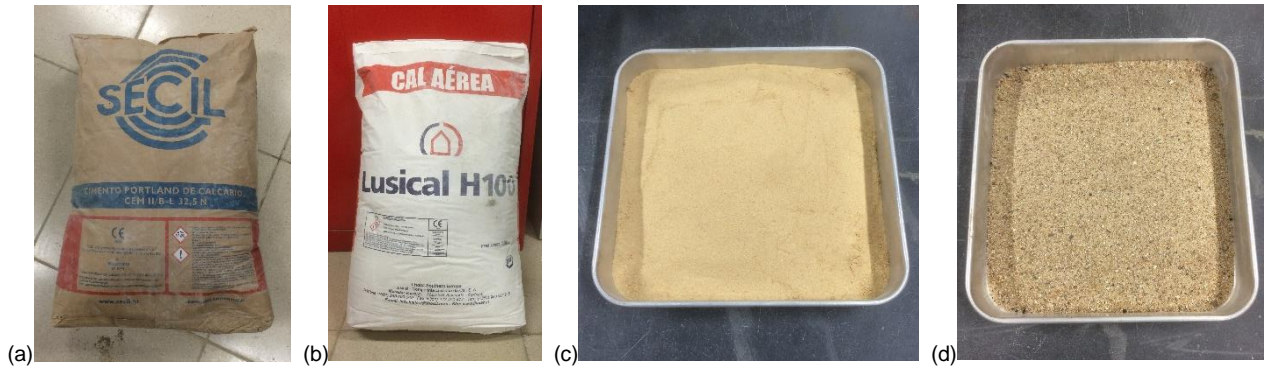
(a) – Cimento; (b) – Cal aérea; (c) – Areia de areeiro; (d) – Areia de rio
