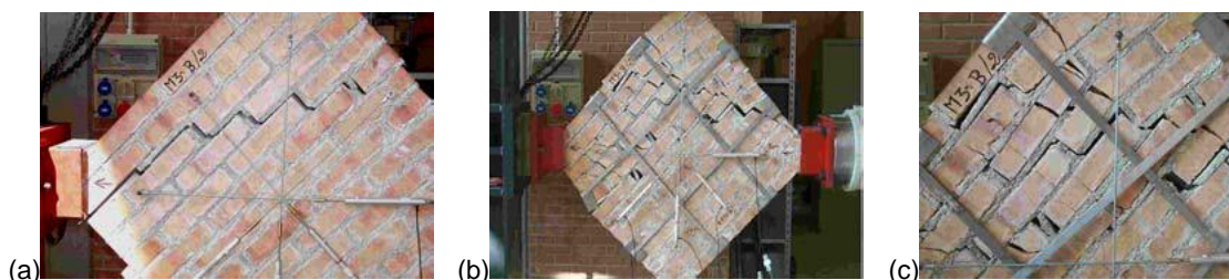
(a) – Rotura do painel simples; (b, c) – Rotura do mesmo painel reforçado com o sistema CAM
