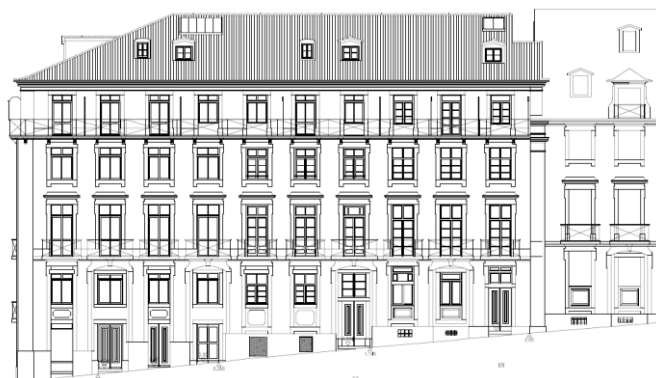
Figura 2.13 – Alçado de um edifício Pombalino [2]
