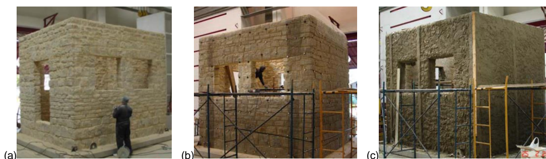
(a) – Modelo não reforçado verticalmente; (b) – Modelo reforçado verticalmente; (c) – Modelo rebocado
