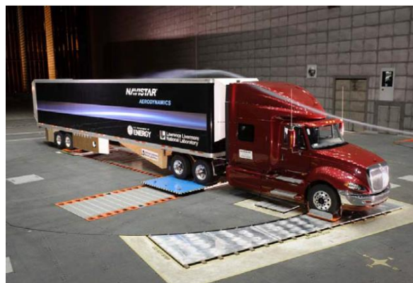
Figura 2.9-Função do defletor superior na aerodinâmica de um caminhão. Fonte: Patten et al. (2012).
