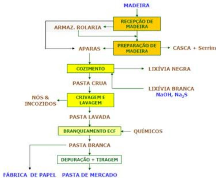
**Figura 4.1: Processo de fabrico de pasta**
