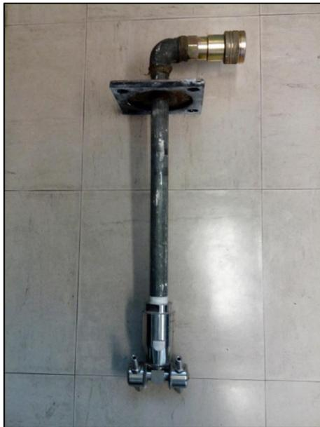
**Figura 22:** Cabeça de lavagem fixa no sistema de encaixe criado pela Tintas Robbialac S.A.
