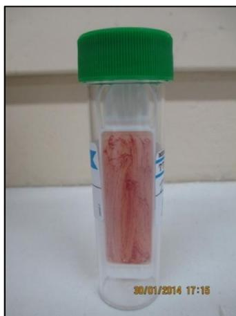
**Figura 36:** *Dipslide* do teste na tampa do depósito 43.
