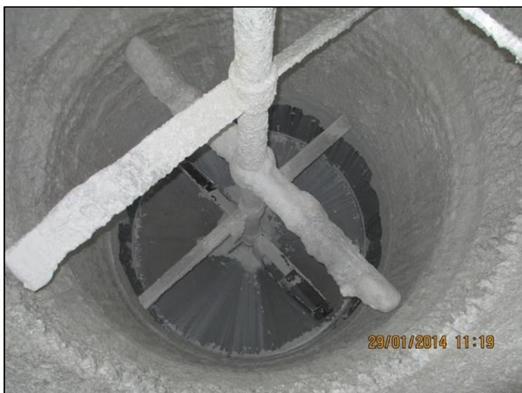
**Figura 8:** Depósito com produto solidificado a necessitar de limpeza profunda.
