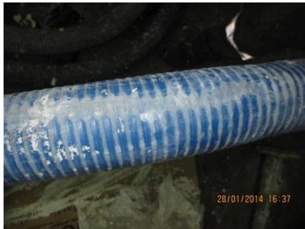
**Figura 32:** Desgaste na mangueira móvel devido ao atrito com o cimento do chão da fábrica.
