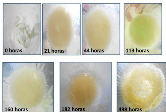
Figura 4-6 – Evolução do aspeto de uma solução de 6% MC, durante o período de hidratação.
