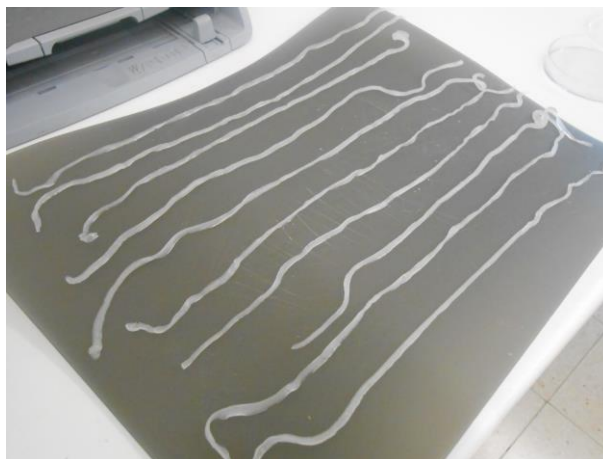
Figura 3-4 – Fios de Metilcelulose antes de se iniciar o teste de tensão axial.
