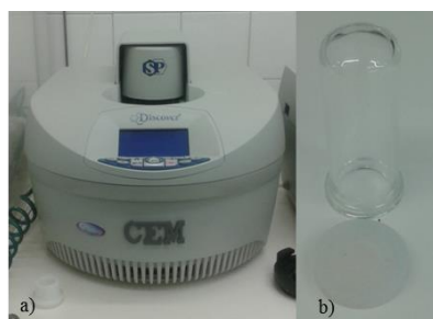
Figura 3.1. A) Micro-ondas usado na síntese das nP's de WO 3 (marca: Discover Synthesis Platform® da CEM Corporation). B) Recipiente apropriado para o micro-ondas.
