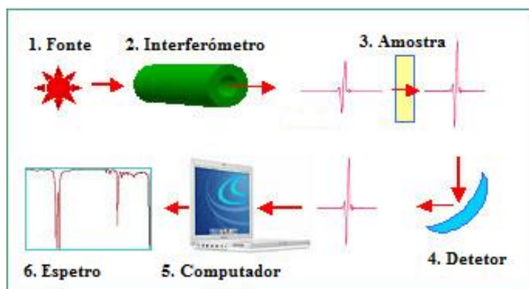
Figura 4.2. Imagem esquemática dos passos para obter um espectro de IV.
