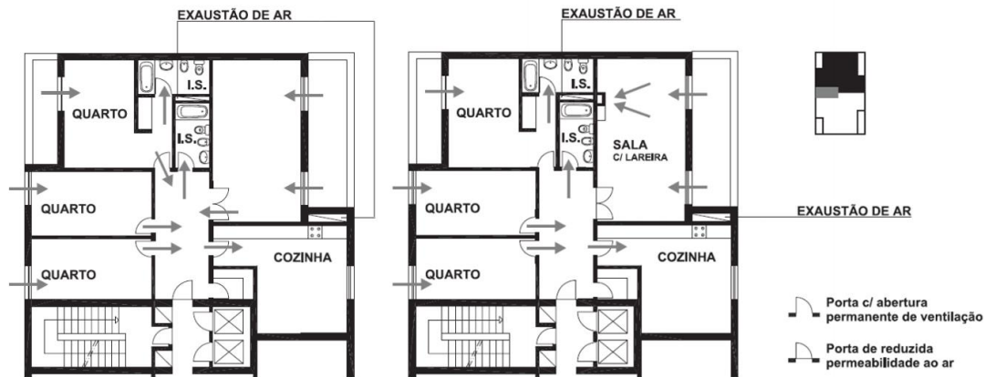
Figura 4.8 – Esquemas de ventilação – conjunta (esquerda) e separada (direita)
