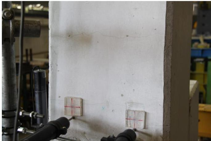
Figura 4.21 - Fendilhação na Viga – Ensaio 3
