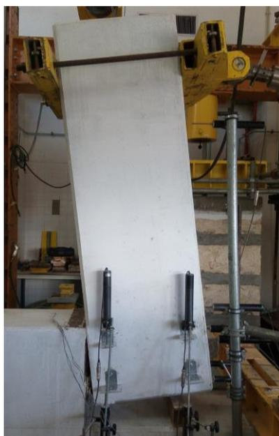
Figura 4.16 - Inclinação Final da Viga - Ensaio 2
