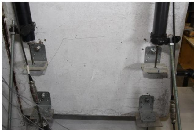
Figura 4.62 - Fendilhação na Viga – Ensaio 6
