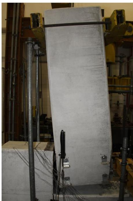
Figura 4.71 - Inclinação Máxima Positiva - Ensaio 6
