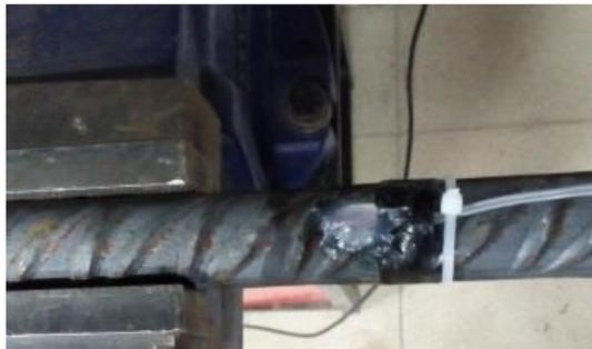
Figura 3.17 - Proteção de Extensômetro com Silicone
