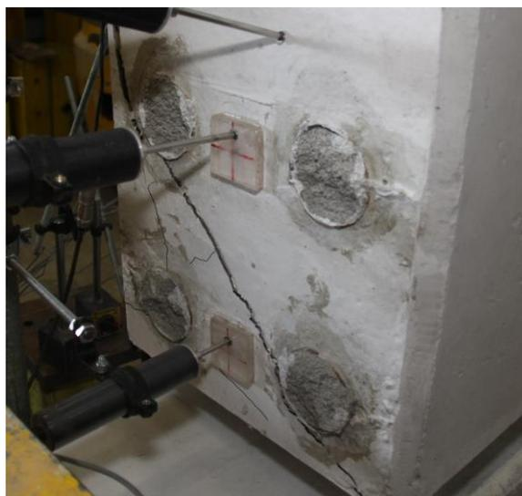
Figura 4.64 - Destacamento do Betão – Ensaio 6
