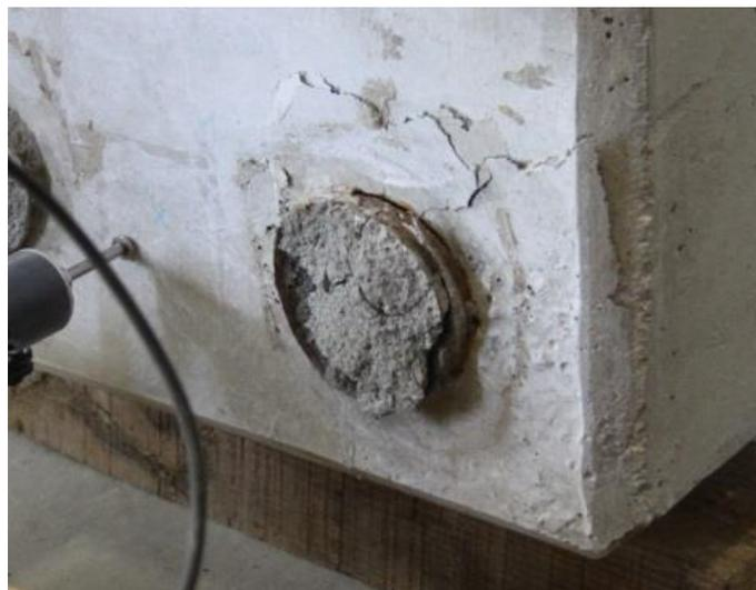
Figura 4.27 - Baínha Inferior Após Ensaio
