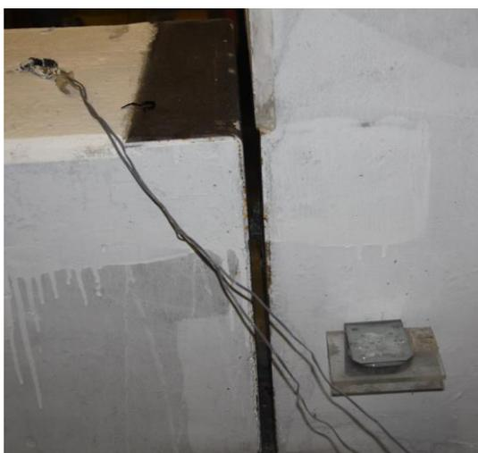
Figura 4.5 - Afastamento da Viga em Relação ao Pilar Após Ensaio - Ensaio 1
