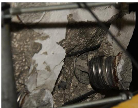
Figura 4.69 - Rotura da Baíña – Ensaio 6
