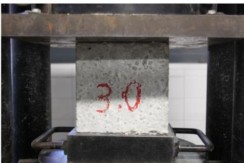
Figura 3.22 - Ensaio à Compressão de um Provede Cúbico
