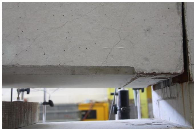
Figura 4.22 - Fendilhação na Face Inferior da Viga
