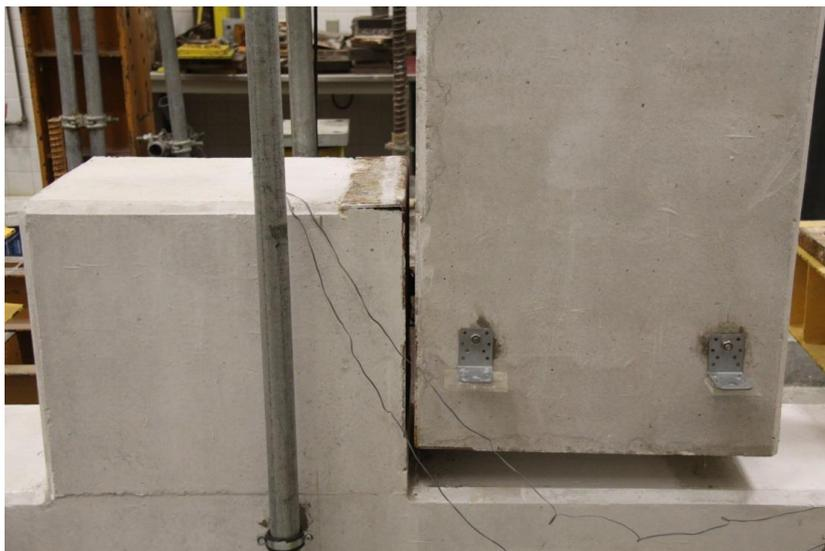
Figura 4.36 - Aspeto do Modelo no Final do Ensaio
