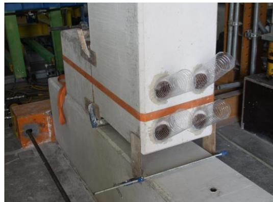
Figura 3.35 - Fixação da Viga
