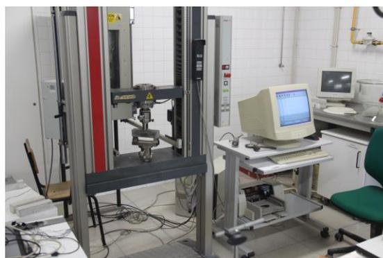
Figura 3.26 - Ensaio à Flexão dos Provetes de Grout
