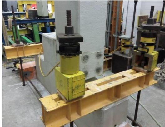
Figura 3.36 - Aplicação do Pré-esforço
