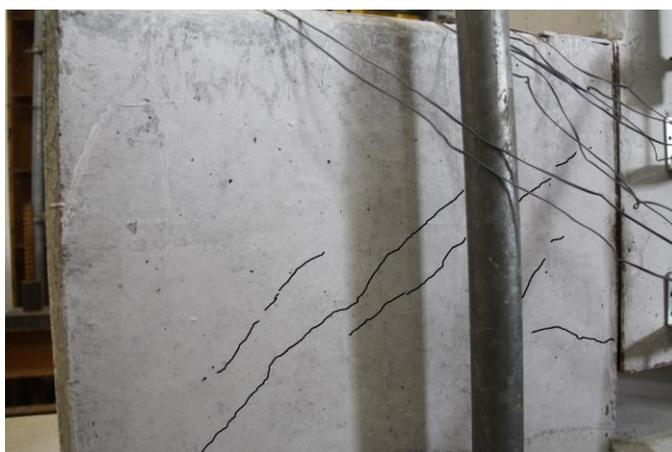
Figura 4.59 - Fendilhação no Cachorro – Ensaio 6
