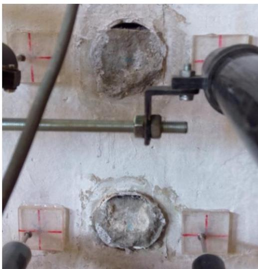
Figura 4.11 - Baínhas da Viga - Ensaio 2
