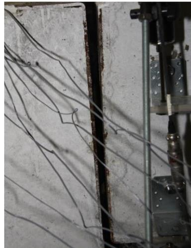
Figura 4.67 - Afastamento Entre Chapas – Ensaio 6
