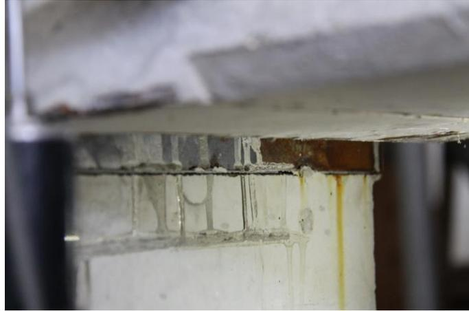
Figura 4.20 - Deformação na Chapa da Consola Curta – Ensaio 3
