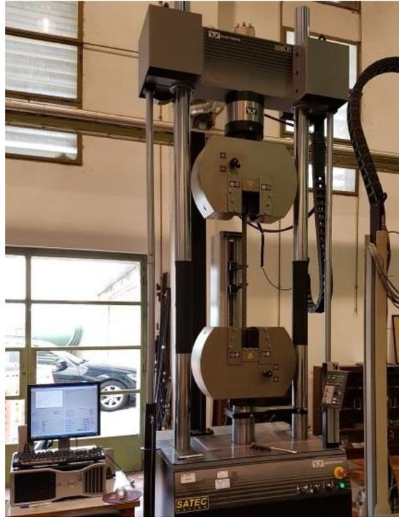
Figura 3.19 – Ensaio do Varão à Tração
