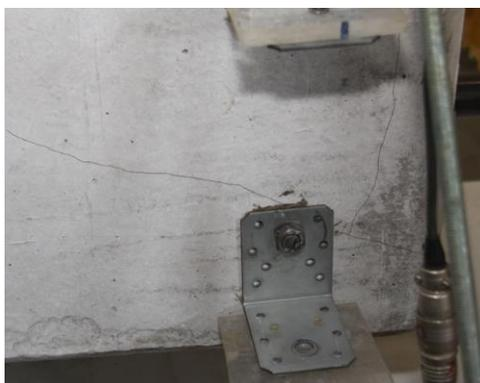
Figura 4.63 - Fendilhação na Extremidade da Viga – Ensaio 6
