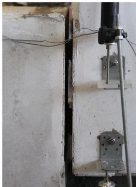
Figura 4.43 - Ligação no Final do 3º Ciclo - Ensaio
