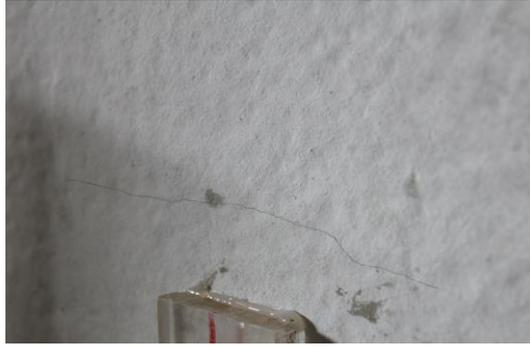
Figura 4.60 - Abertura de Fenda na Zona Superior do Defletómetro 3 – Ensaio 6
