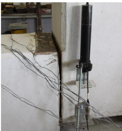
Figura 4.25 - Afastamento Entre Chapas Após Ensaio - Ensaio 3
