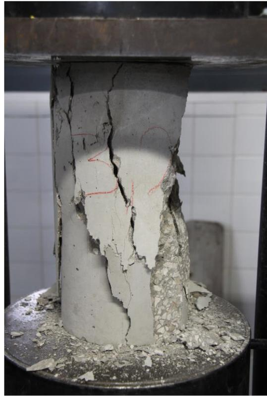
Figura 3.25 - Resultado Após Rotura
