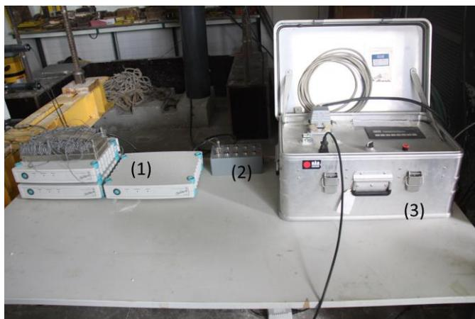
Figura 4.1 . Equipamento de Laboratório – (1) Datalogger; (2) Fonte de Alimentação; (3) Consola de Comando
