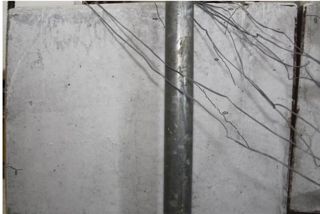
Figura 4.61 - Fendilhação no cachorro – Ensaio 6
