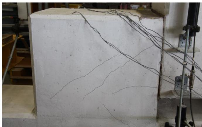
Figura 4.19 - Fendilhação na Consola da Consola Curta – Ensaio 3
