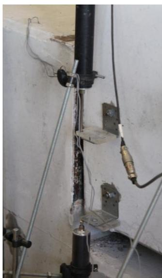
Figura 4.49 - Espaçamento na Zona Inferior da Chapa - Ensaio 5
