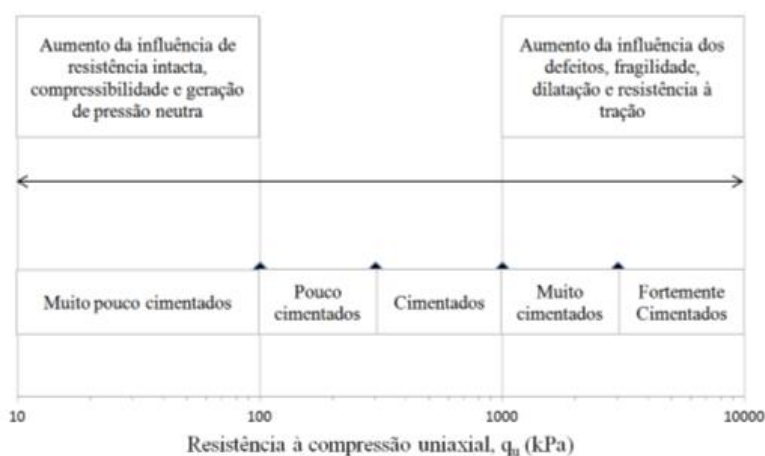
Figura 2.1 - Classificação dos solos cimentados adaptado de (Carvalho et al. 2002)
