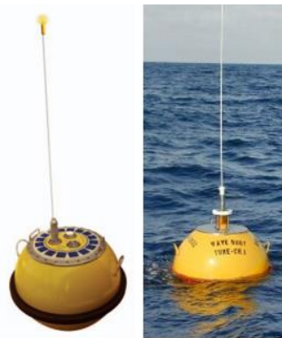
Figura 2.3 - Boia ondógrafo Datawell Waverider [3], [4]
