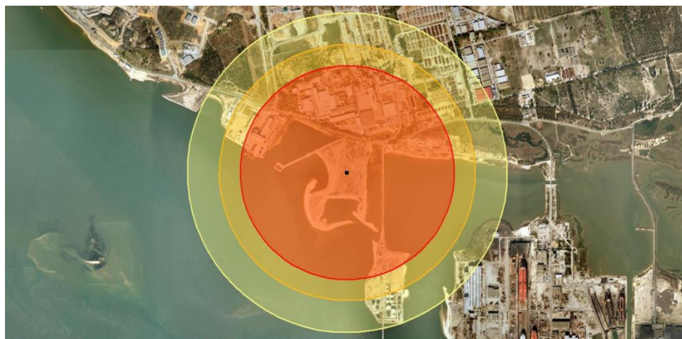
Figura 47 – Cenário de acidente com raios de influência de radiação Térmica Fonte: SMPCB, 2012, p. 78
