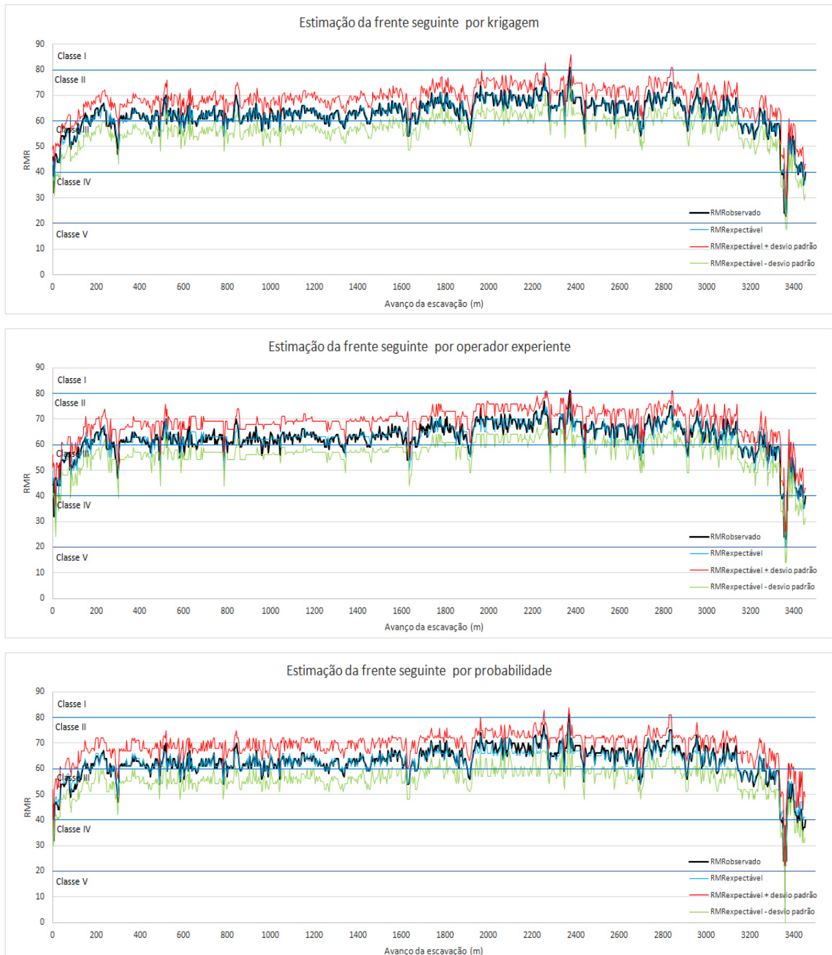
Figura 7.5 – TM: gráficos com os valores de RMR estimados e observados no túnel nascente Sul
