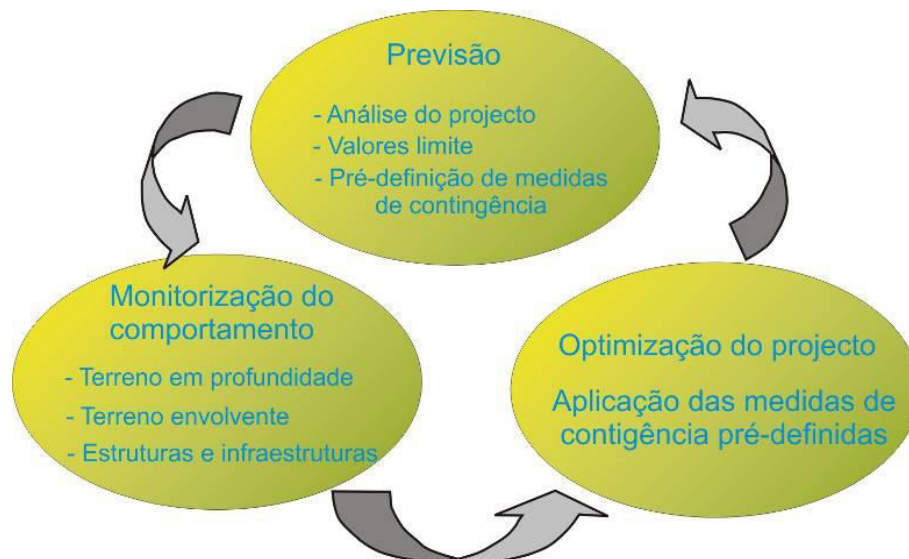
Figura 2.23 – Diagrama de aplicação do plano de avanço do túnel (adaptado de Grasso, 2008)
