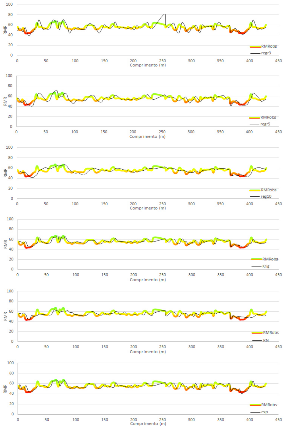
Figura 5.10 – AHB: gráficos do RMR observado e estimado em avanço, pelos diferentes métodos ao longo da escavação
