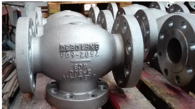
Figura 3.5 – Corpo válvula globo
