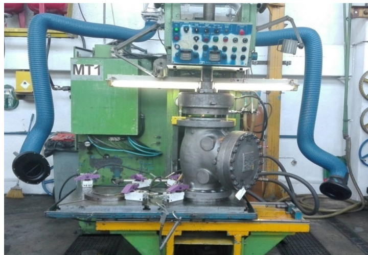
Figura 3.17 – Máquina de testes um a ensaiar uma válvula (MT1)
