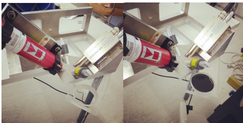
Figura 4.7. Montagem completa para análise de amostras de óleo, à esquerda sem a amostra de óleo; à direita com amostra de óleo.
