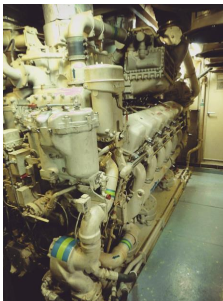
Figura 3.5. Motor MTU de 12 cilindros, do Navio Cacine da Marinha Portuguesa.
