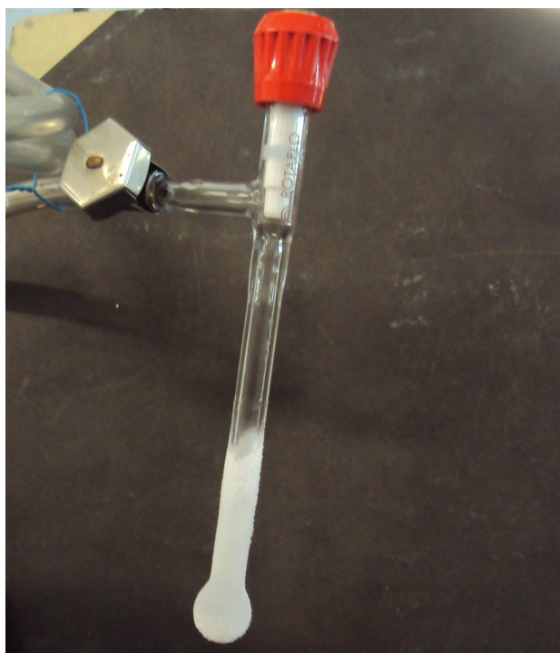
Figura 4.1: Sistema utilizado para a introdução de metanol no interior da câmara de ionização.
