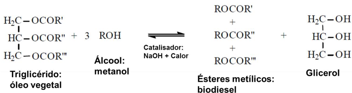
Figura 2.3 – Esquema geral da reacção de transesterificação dos óleos vegetais. Adaptado de Schuchardt et al. , 1998.
