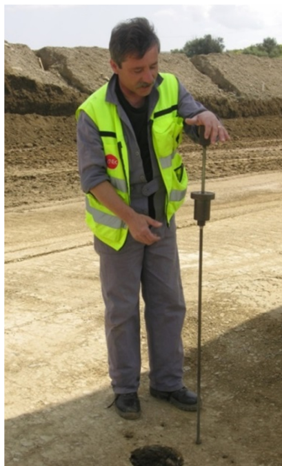
Figura 3.8 – Ensaio com Penetrómetro Dinâmico Ligeiro adaptado pelo LNEC, PDL_L .
