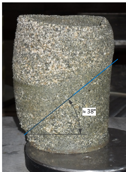
Figura 5.43 – Provete com formação da superfície de rotura produzida durante a fase de corte: exemplo do ensaio Sat_08 (60, 5).
