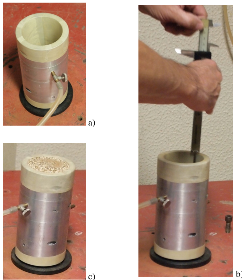
Figura 5.28 – a) Ajuste da membrana ao molde; b) controlo da espessura de cada camada; c) preenchimento total do molde.
