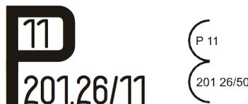
Figura 2.8 – Simbologia de controlo metrológico relativo à "Aprovação do Modelo" (IPQ & UML, 2011)
